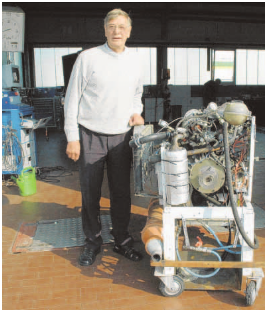
Weltweite Patente angemeldet: Uwe Hansen mit dem von ihm entwickelten Hybrid-Motor. Vorne links – in Alu-Isolierung – der spezielle Wärmetauscher. Das orangefarbene Rohr unten links ist der Auspuff. Nachdem die heißen Abgase für den Motorantrieb genutzt und abgekühlt worden sind, bringen sie nicht einmal mehr ein Plastikrohr zum Schmelzen. Foto: Höfer
